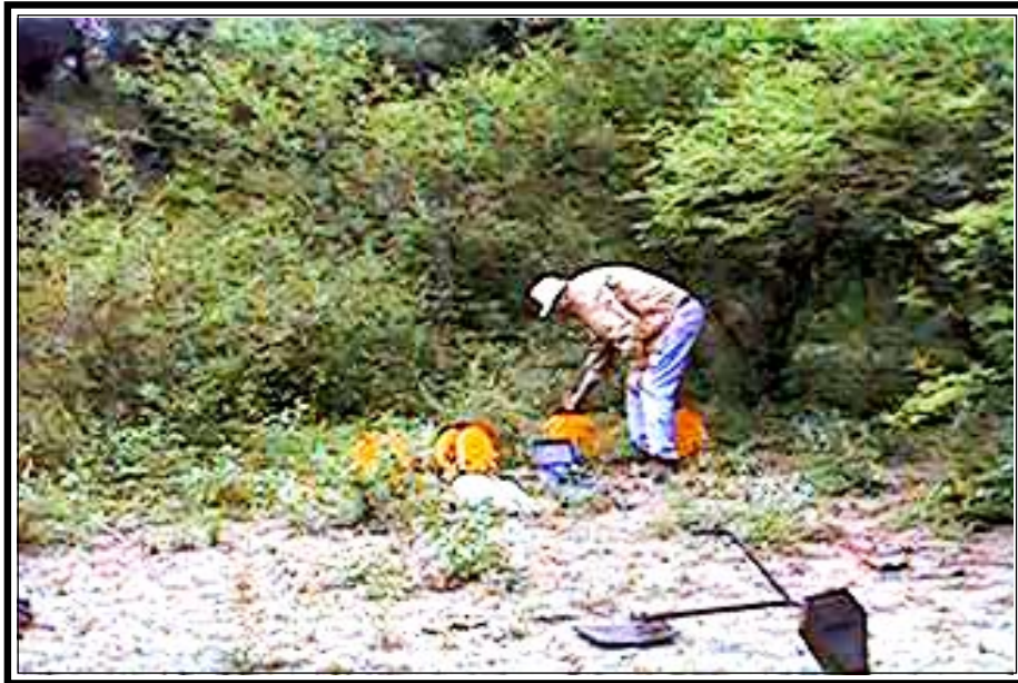
Mediciones de resistencia aparente en Cráter La Victoria
